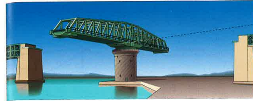
DRAAIBRUG v SWING BRIDGE PONT m TOURNANT DREHBRÜCKE f
